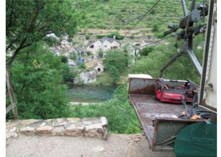
Un système de bacs permettant de traverser le Tarn, et un téléphérique au-dessus de la rivière servent au transport des marchandises et du courrier.
