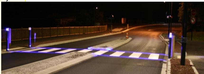
Une innovation a été posée pour la sécurisation du passage piéton à l'entrée de la ville. Nous avons installé la solution S-PASS proposée par ABEL. 4 bornes piétons haute-visibility à LED ont été posées pour créer un marquage lumineux bleu traversant le long du passage piéton. Nous espérons ainsi éveiller
